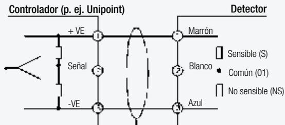
Resistencia máxima de lazo del cable 33 ohmios
