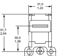
Apertura frontal para llave con característica de retención (retención de llave por fricción)
