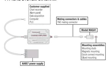
Model MAQ41 Accelerometer
